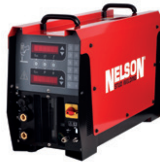
N 1500i Flexibles Inverter Bolzenschweißgerät Schweißstrom 30-1500A stufenlos Interface für Betrieb mit Bolzensortierer / externer Maschinensteuerung Schweißleistung \varnothing 3mm bis \varnothing 19mm
